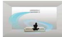
Aparatul de aer condiționat direcționează automat fluxul de aer de la stânga la dreapta. Când fluxul de aer trece peste o persoană, viteza de oscilație crește brusc pentru scurt timp, apoi scade, creând senzația unei adieriri.
